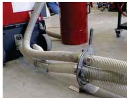
Съемная установка с применением переключателя для смены режимов выдувки и экстракции.
