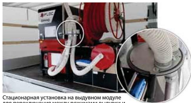
Стационарная установка на выдувном модуле для переключения между режимами выдувки и экстракции.
