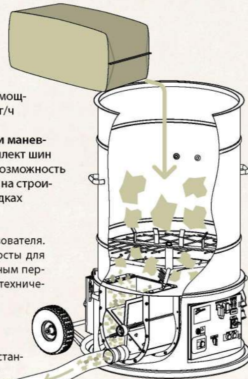
Принцип работы серии M95
